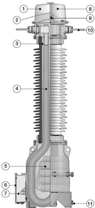
**Transformador de intensidad tipo IMB**
